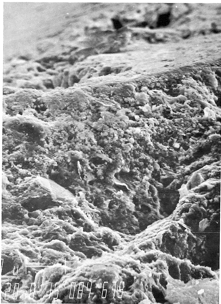
Fig. 1. — Enduit ocre mat. Alternance de couches massives et de couches globulaires. La couche massive du bas présente une surface botryoïde (flèche) attribuée à une activité bactérienne. Échelle : 10 \mu m.
