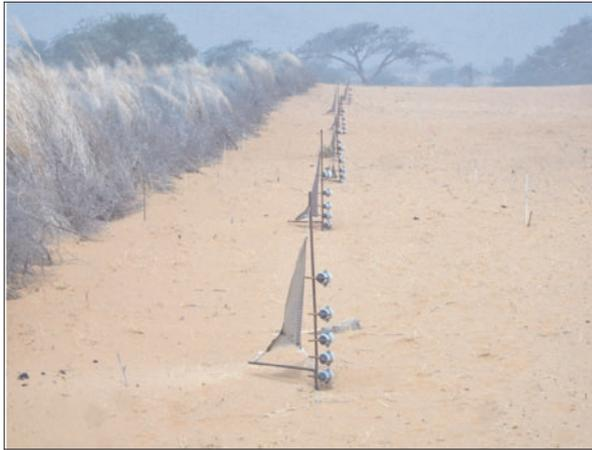
Figure2: Capteurs de sédiments (MWAC) installés à 3 m au vent par rapport à la première palissade de *Leptadenia pyrotechnica* sur la dune vive de Tchago.
