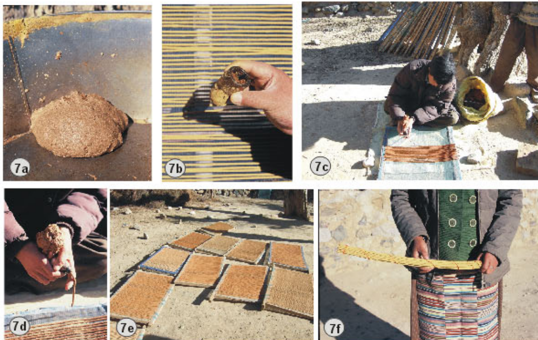
Figures 7 : Fabrication of incense sticks (F. Malaisse)
