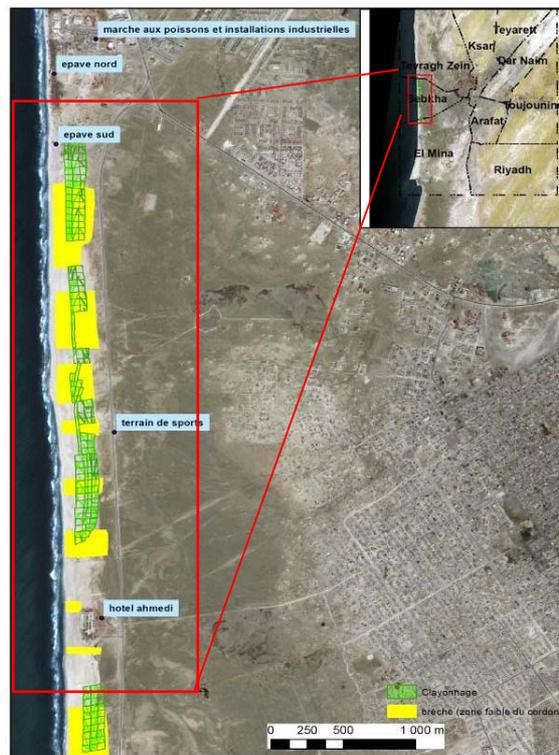
**Figure 3 :** Site pilote de la protection du cordon littoral par un système de clayonnage.
