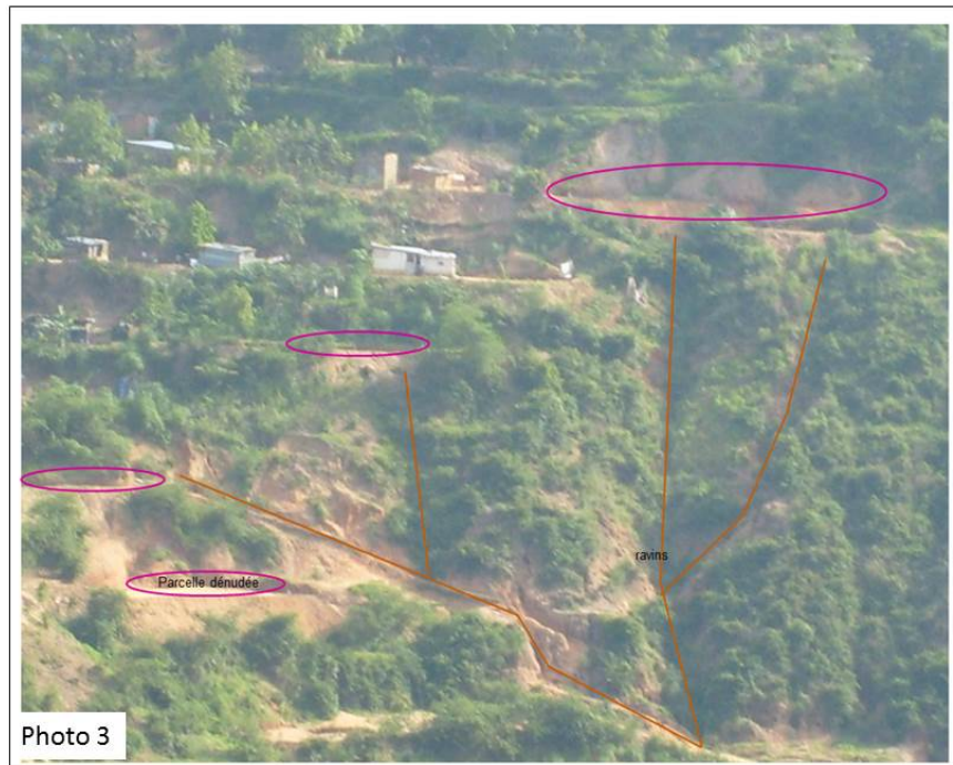
Photo 3. Disposition de l'habitat en gradin sur le versant ouest de la Kwambila, au sud de Kisenso, et ravinement subséquent (Photo Kayembe, juin 2008)
