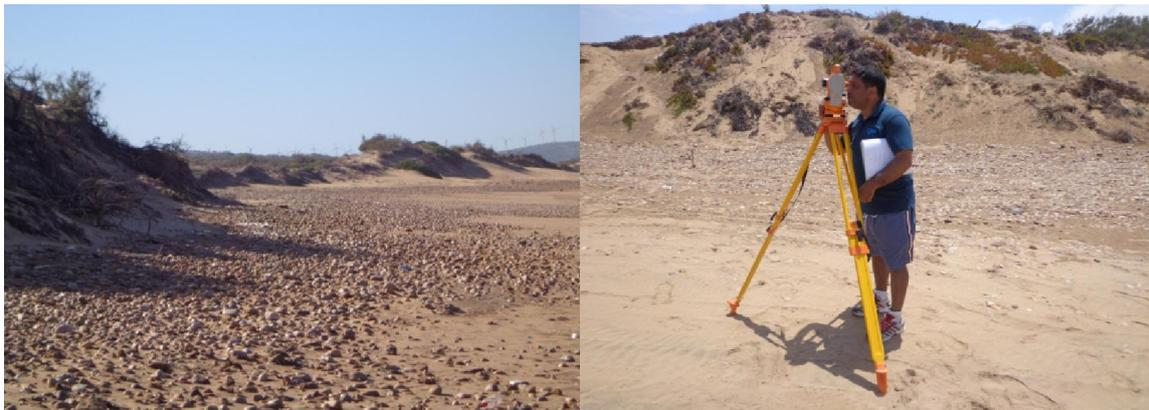
**Photo 2** : Suivi expérimental des levés topographiques par tachéomètre des radiales plage/dune du cordon dunaire de Diabet-Essaouira (Clichés L.HOUARI, 5/2/2014).
